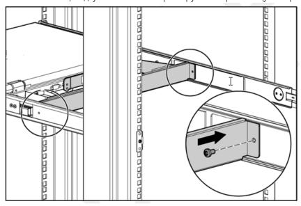
7. Снимите два винта 6-32 на задней стороне устройства.
