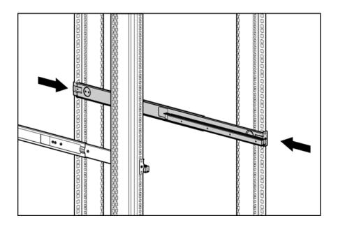
ПРИМЕЧАНИЕ: В случае, если не удается зафиксировать регулируемые рейки UPG 1U, которые монтируются без инструмента, необходимо убедиться в том, что их отверстия совпадают с отверстиями на стойке. Отверстия на стойке должны быть размещены одинаково на передней и на задней части стойки.
