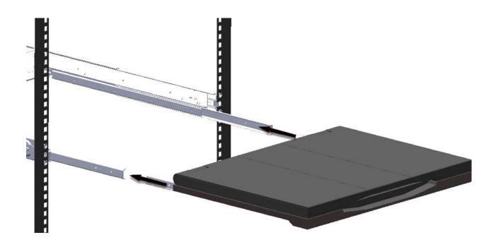
4. Вставьте направляющую в сборе с задней части стойки между регулируемыми рейками UPG1U, которые монтируются без инструмента
