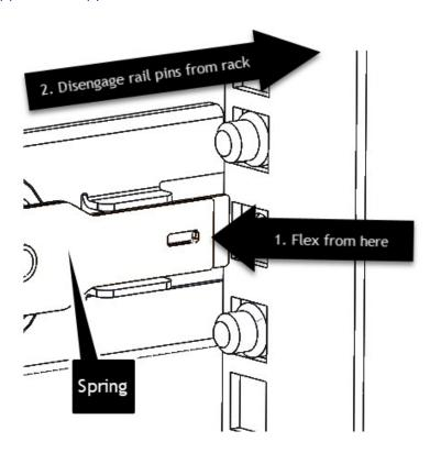
4. Повторите предыдущие шаги для другой регулируемой рейки UPG 1U, которая монтируется без использования инструментов.
