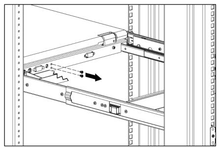
8. Закрепите фиксаторы для кабеля на задней части устройства двумя винтами 6-32. [8 in-lbs]
