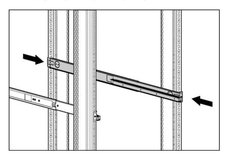
附註:若無法將UPG 1U可調式免工具導軌壓入,請確認其是否已對準導軌上標示的安裝孔;此時,標示於導軌上的安裝孔必須位於導軌前後方的相同位置。
