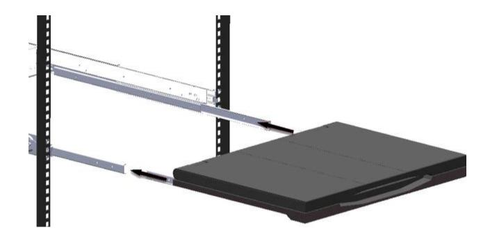
4. 從機架後方將橫撐條導軌總成推入UPG 1U可調式免工具導軌之間。
