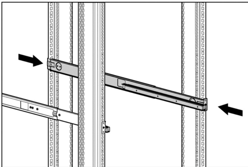
**NOTA :** Si los rieles ajustables sin herramienta UPG 1U no se encajan, hay que asegurarse de que estén alineados con los agujeros marcados sobre el bastidor. Los agujeros marcados sobre el bastidor deben de estar al mismo nivel en la parte delantera y trasera del bastidor.
