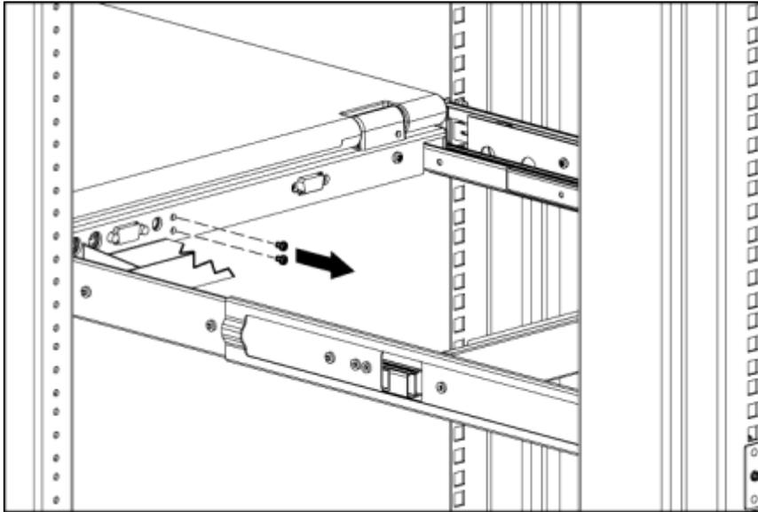
8. 利用这两支6-32螺钉将电缆管控杆固定于装置的后方。[8 in-lbs]
