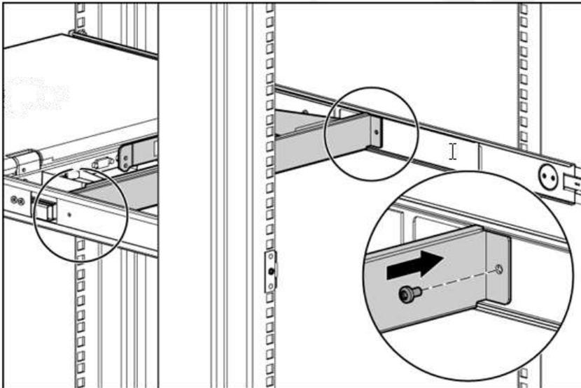
7. 从装置的后方拆下两支6-32螺钉。
