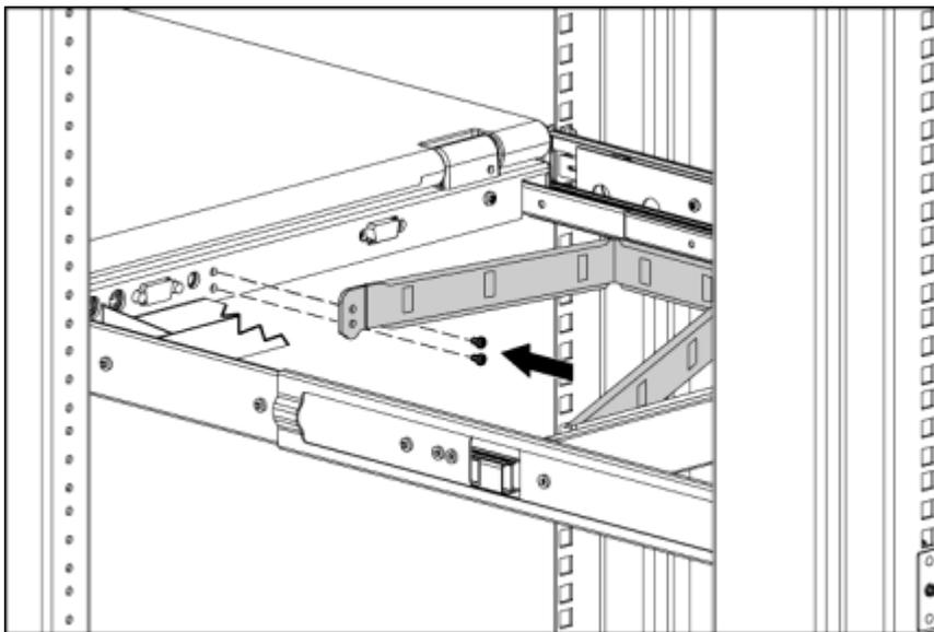
9. 连接电缆，并将它穿过电缆管控杆及装置的开口。
