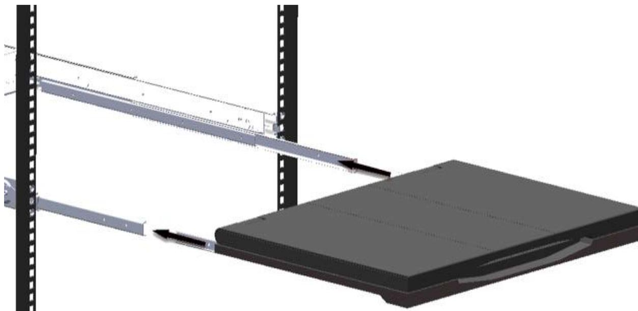
4. 从机架后方将横撑条导轨总成推入UPG 1U可调式免工具导轨之间。
