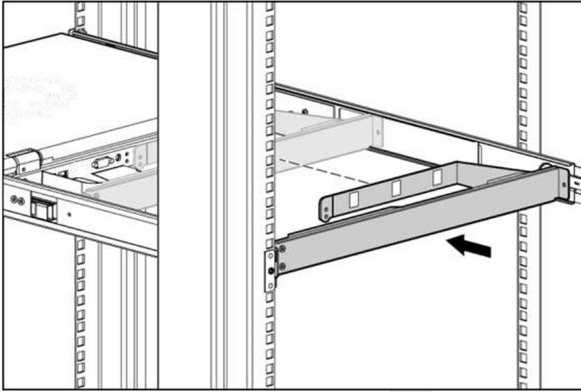
5. 使横撑条导轨上的螺孔对齐UPG 1U可调式免工具导轨的螺孔。
