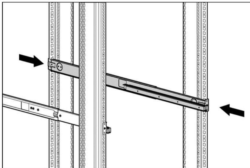
**附注：**若无法将UPG 1U可调式免工具导轨压入，请确认其是否已对准导轨上标示的安装孔；此时，标示于导轨上的安装孔必须位于导轨前后方的相同位置。
